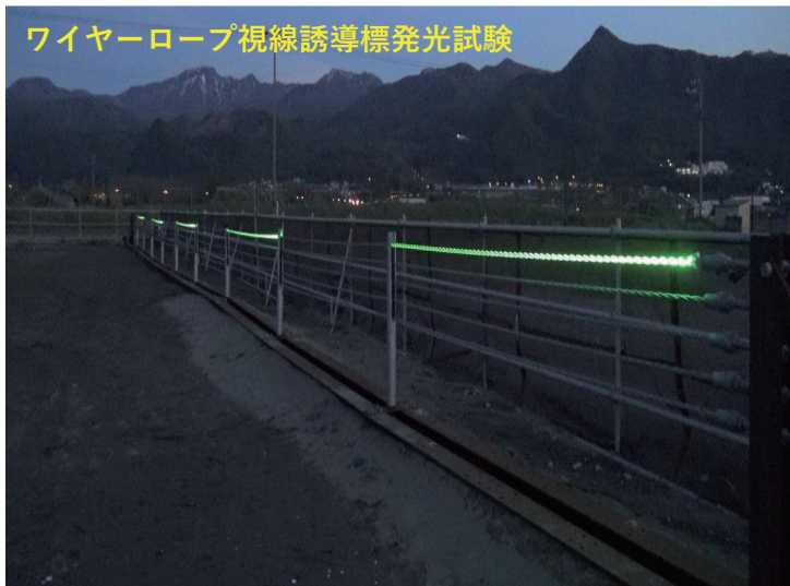
ガードレール視線誘導標発光試験
